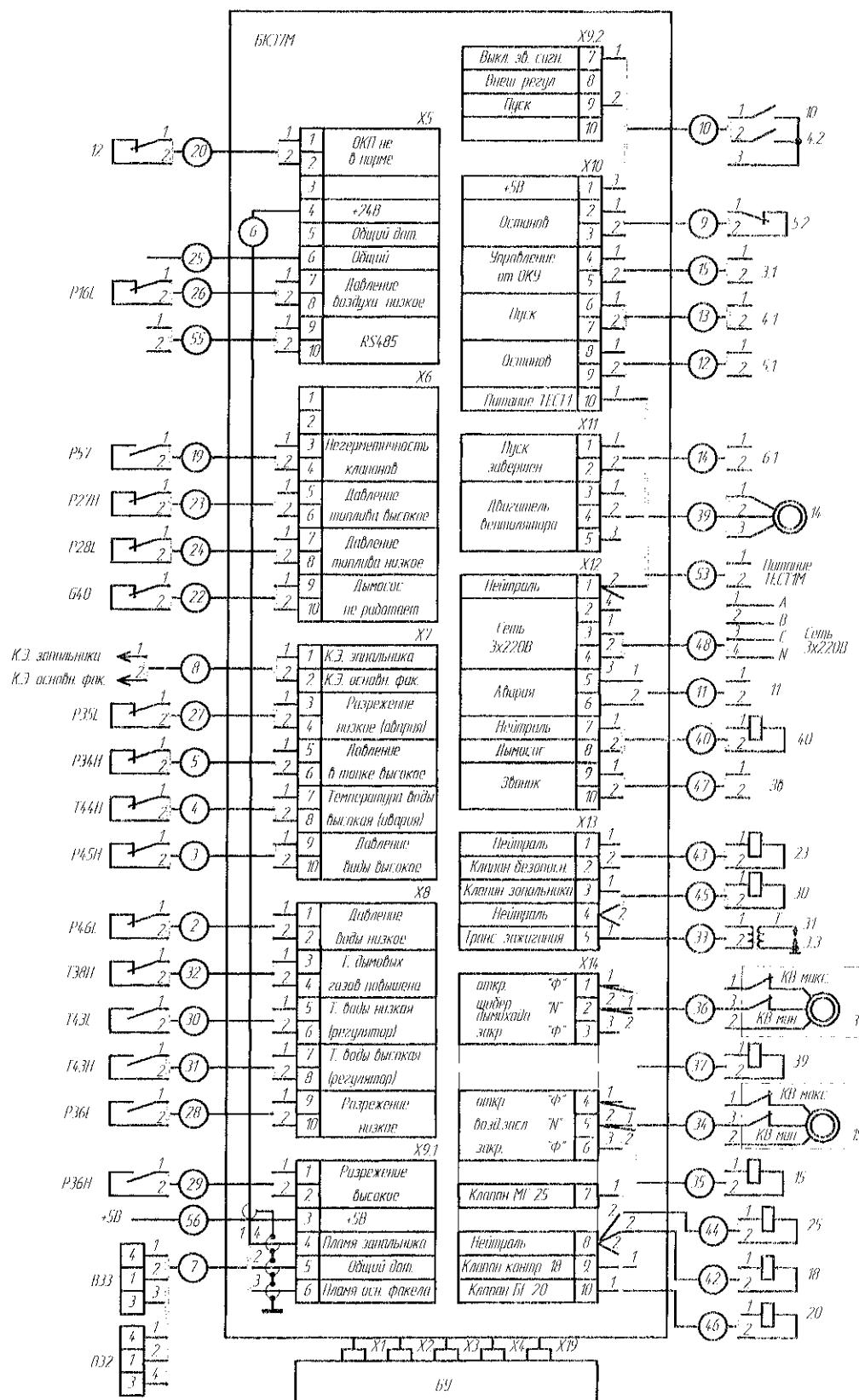
Рис. П.1 Схема подключения БКЭ7М.
