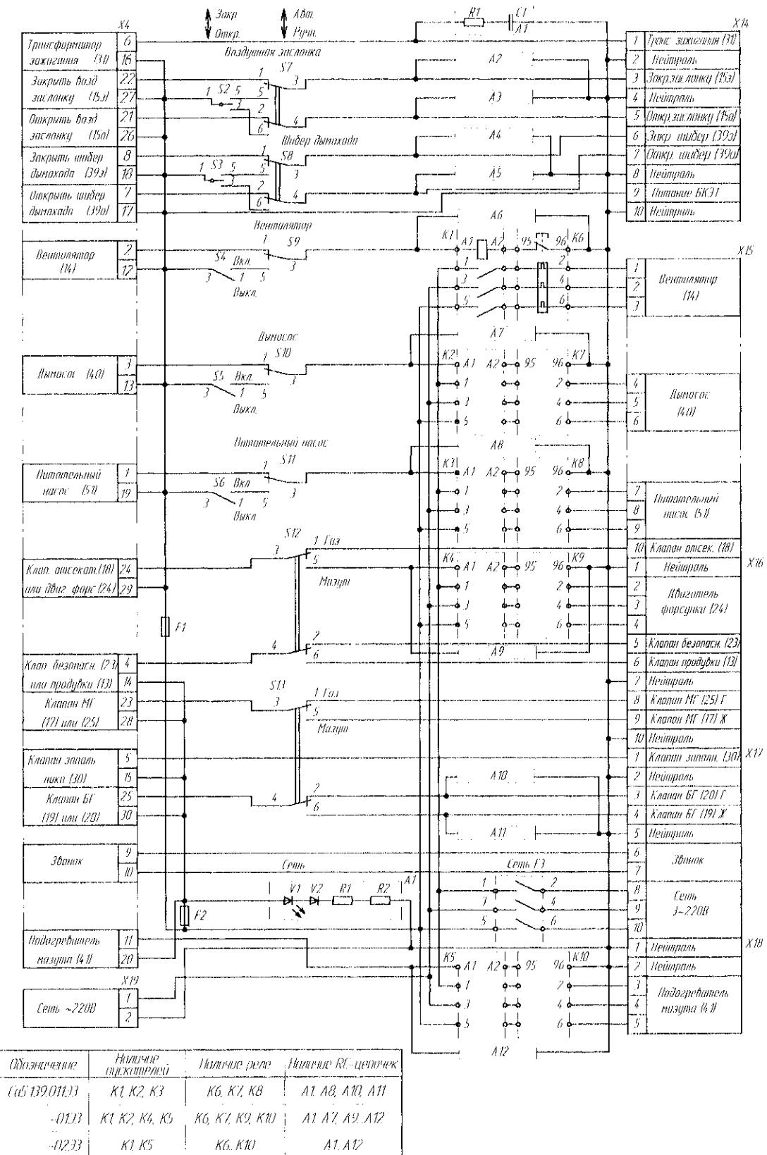
Рис. К.1 Схема электрическая принципиальная блока БКЭ2
